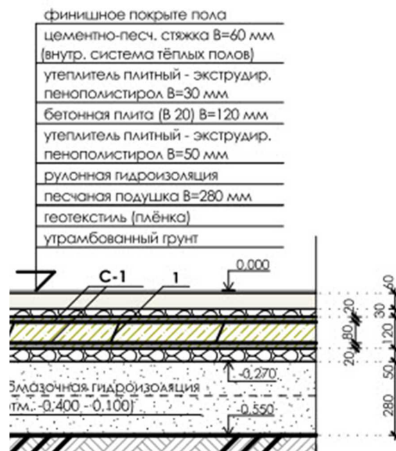
Рис. 9. Предложенное решение для полов по грунту.
