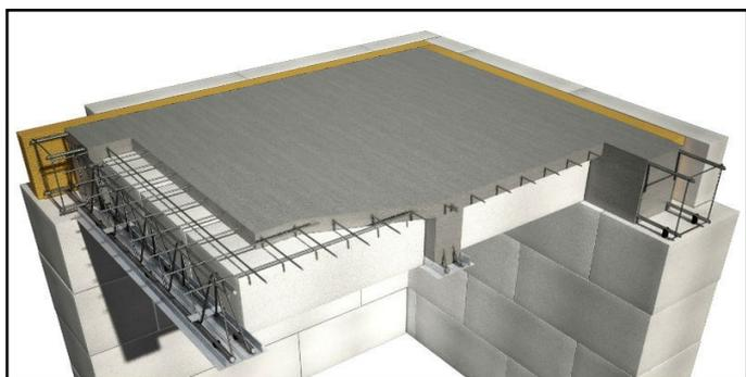
Рис. 12 Монолитный пояс в составе перекрытия
