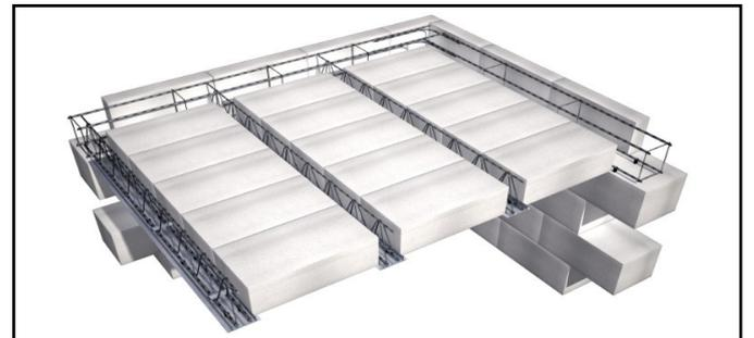
**Рис. 28 Использование перегородочных газобетонных блоков в качестве опалубки периметра перекрытия**
