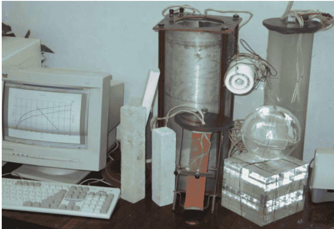
Рисунок 18 - Определение температуропроводности красного кирпича контактным методом Чернышова-Фокина
