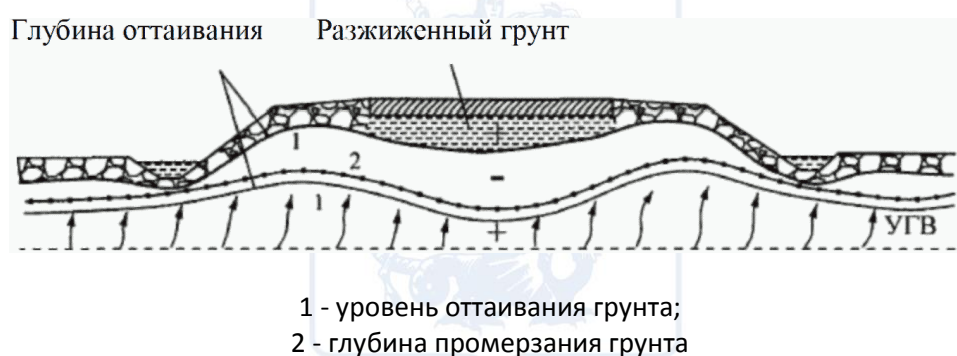
Рисунок 4 - Начало оттаивания грунтов земляного полотна в весенний период
