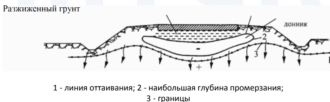
Рисунок 5 - Земляное полотно после повсеместного оттаивания грунтов с неоттаявшим донником
