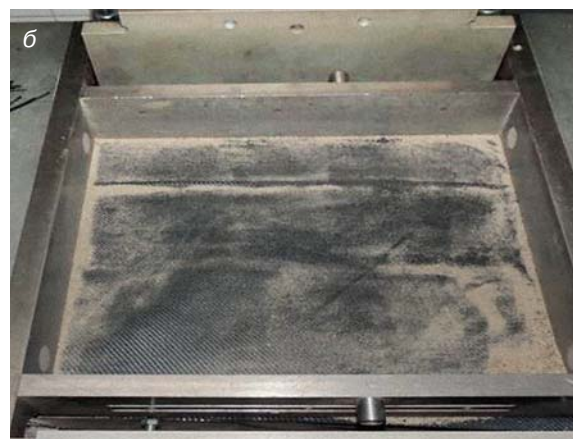
Иллюстрация 3. Геосинтетические материалы: а — георешетка; б — тканый геотекстиль. Автор Д. А. Татьянников
