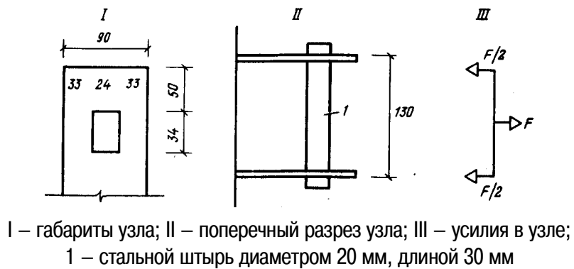
Рис. 10.20. К расчету узла крепления
