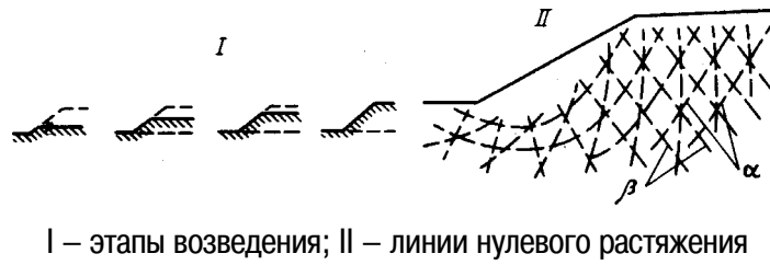
Рис. 5.46. Анализ состояния насыпи методом конечных элементов при наличии арматуры
