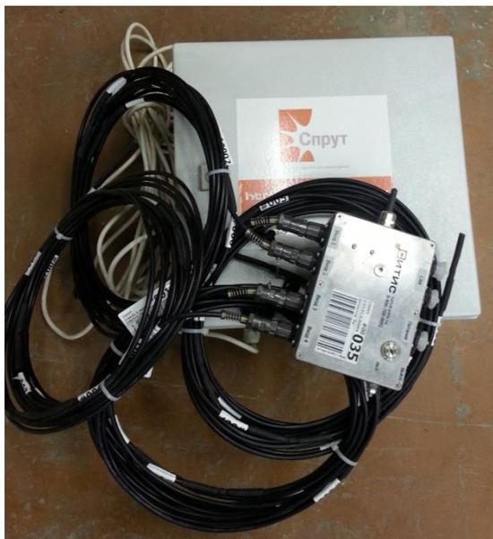
Система Ситис "Спрут" с термодатчиками
