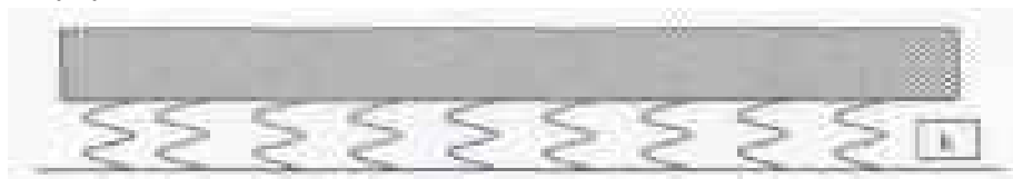
Рисунок Д.1 Фундаментная плита, покоящаяся на термоизоляции, моделируемой совокупностью пружин (схематическое изображение)
